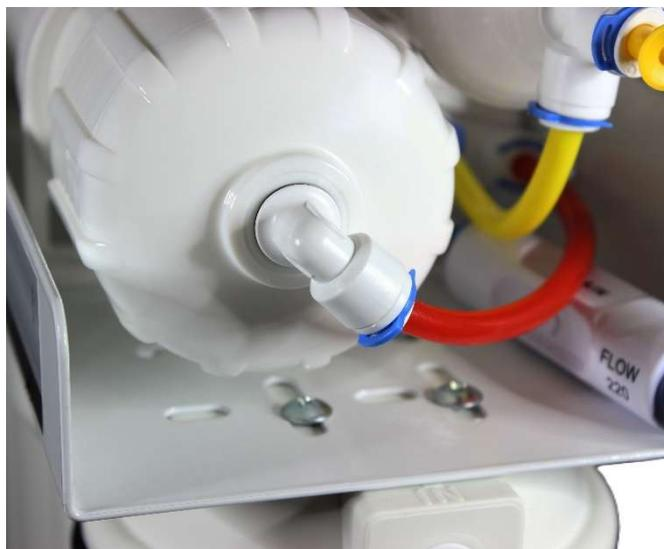
Scegli il luogo in cui verrà installata l'apparecchiatura. Individua la spina nera. Questo identifica l'uscita di scarico, che sarà collegata al collare di scarico. Per rimuovere il cappuccio nero, la clip blu verrà prima rilasciata dal connettore. Basta tirare la linguetta blu della clip verso l'alto. Poi, con l'aiuto dell'attrezzo in dotazione, eserciteremo una pressione sul collare bianco verso l'interno del riduttore di flusso e contemporaneamente rimuoveremo il tappo nero.
