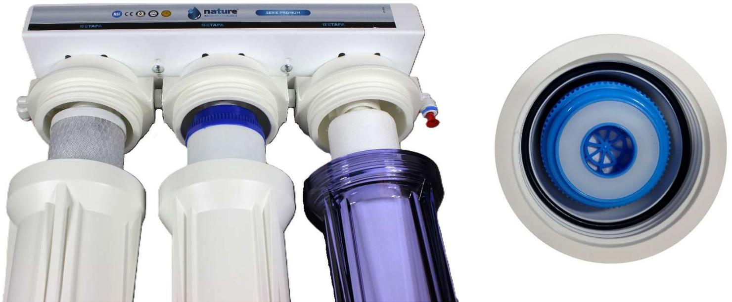
Nach dem ursprünglichen Schema, Seite 3. Der erste Filter ist der Sedimentfilter; Unabhängig von der Position. Im zentralen Bereich wird der Aktivkohlegranulatfilter installiert. Diese muss eingebaut werden, wobei das Teil, das mit einer Fuge versehen ist, oben auf der Scheibe verbleibt. Der dritte Filter ist der des Aktivkohleblocks, der ebenfalls keine definierte Position hat.
