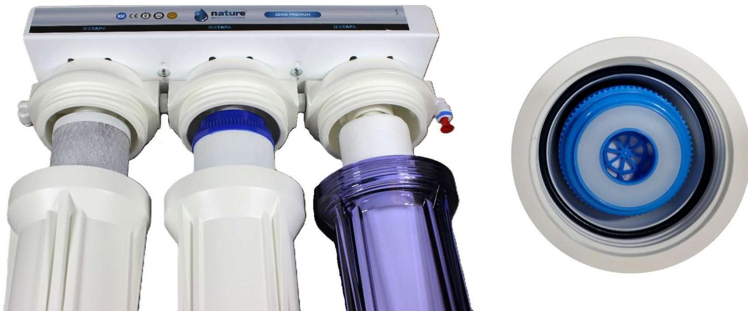
Según el esquema inicial, Pág. 3. El primer filtro es el de sedimentos; no importa la posición. En la zona central se instalará el filtro de carbón granulado. Este si tiene que instalarse, la parte provista de una junta, quedando en la parte superior del vaso. El tercer filtro es el del carbón block que tampoco tiene posición definida.
