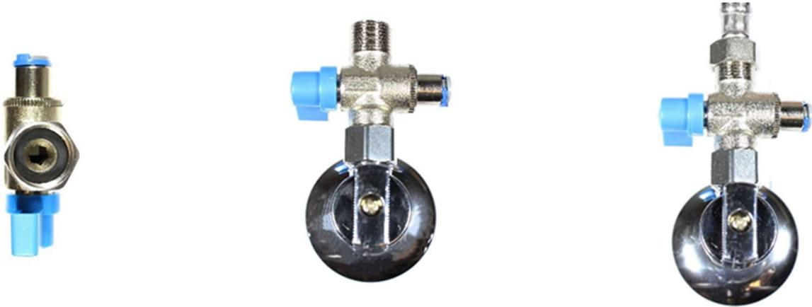
Para conectar la tubería de suministro al equipo, extraemos el clip de seguridad e insertaremos un extremo de la tubería roja hasta el tope. Colocaremos el clip de seguridad.
