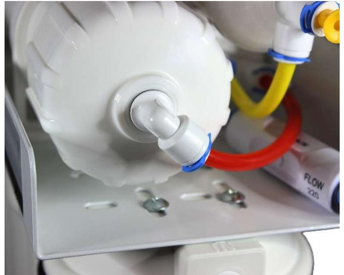
Elegir el lugar en donde quedará instalado el equipo. Localizar el tapón negro. Este identifica la salida de desagüe, que se conectará al collarín de desagüe. Para extraer el tapón negro, previamente se soltará el clip azul del conector. Solo se debe tirar de la pestaña azul del clip hacia arriba. Después ayudados de la herramienta suministrada, ejerceremos presión en el collarín blanco hacia el interior del reductor de flujo y al mismo tiempo extraeremos el tapón negro.
