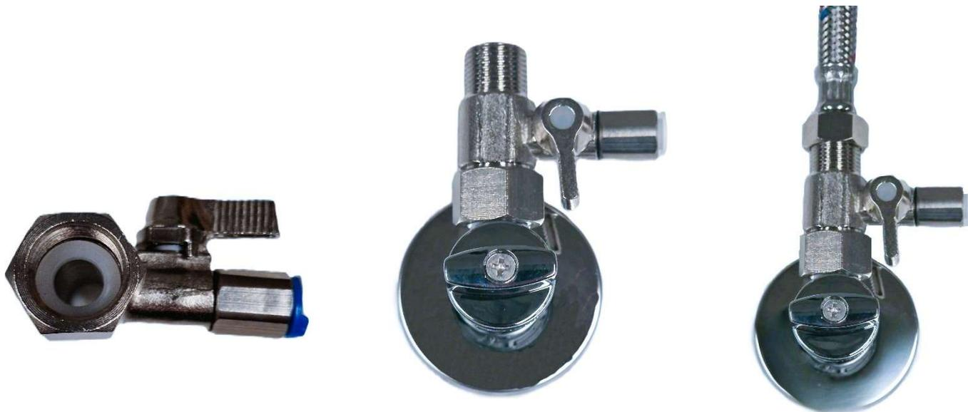
Per collegare il tubo di alimentazione all'apparecchiatura, rimuoviamo la clip blu dal connettore della chiave, inseriamo il tubo in dotazione fino in fondo, posizioniamo la clip blu nella sua posizione originale.
