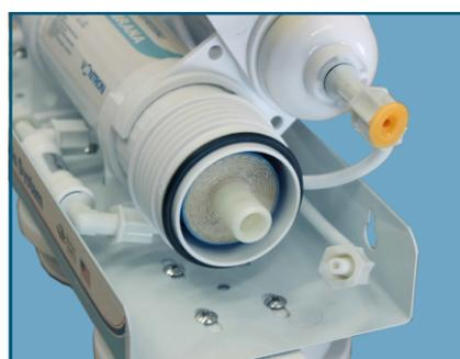
Colocar la tapa anteriormente retirada, verificando que la junta está en la posición correcta en el porta-membrana. Ajustar firmemente con la llave correspondiente. Por último recolocar la rosca en el codo, verificando previamente que en el interior de la tubería está el casquillo de refuerzo.
