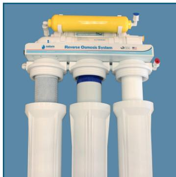
Según el esquema inicial, el primer filtro es el de sedimentos; no importa la posición. En la zona central se instalará el filtro de carbón granulado, la parte provista de una junta quedará en la parte superior. El tercer filtro es el del carbón block que tampoco tiene posición definida.
