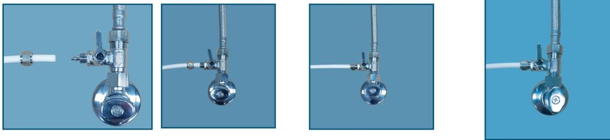
**8** Localizar el filtro de minerales. En un extremo está el tapón azul, desenroscar y desechar el tapón. Colocar la tuerca en el extremo de un nuevo tramo de tubería, insertar un casquillo de refuerzo y ajustar al codo.
