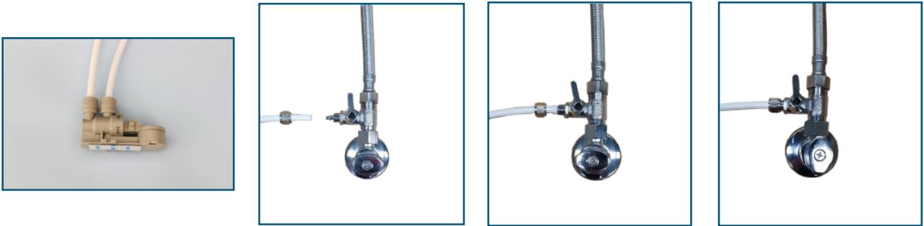
Medir y cortar otro trozo de tubo que colocaremos desde la salida “OUT” del sensor de humedad hasta la entrada de agua del equipo de ósmosis (Tapón azul), desechar el tapón, colocar el tubo y volver a poner el clip de seguridad. Finalmente en este tramo de tubería intercalaremos el “Regulador de presión” teniendo en cuenta la dirección del flujo de agua señalada con una flecha sobre el mismo.
